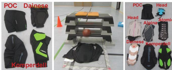
Abb. 1: Getestete HP (links) und RP (rechts), Messaufbau (Mitte, Fallhöhe 65 cm)
